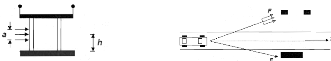
Obrázek 11. Kolizní síla na nosné spodní stavby v blízkosti jízdních pruhů pro mosty a nosné konstrukce budov
