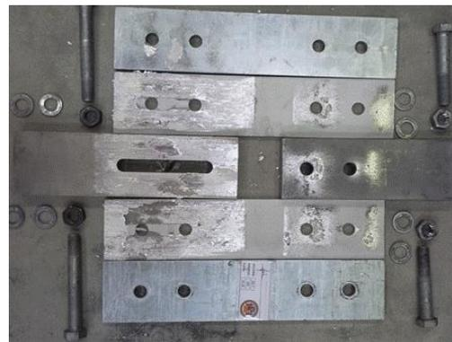
Figure 2.40 : Dommages des cales M4
