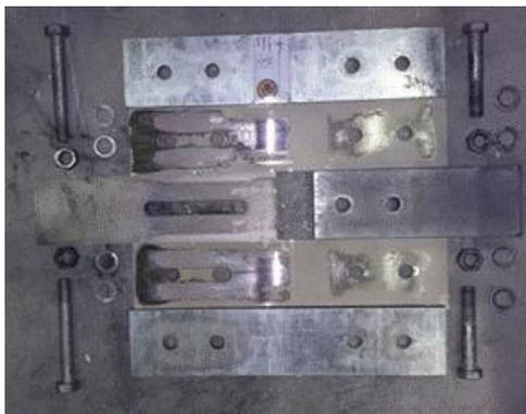
Figure 2.39 : Dommages des cales M1
