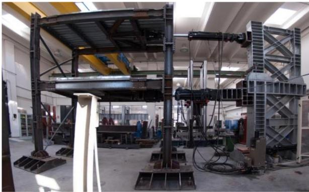
a) Maquette avec assemblages RBS
