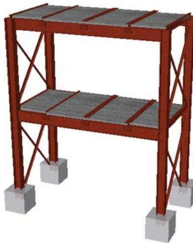
Figure 6.22 : Modèle 3D de la maquette avec connexions RBS
