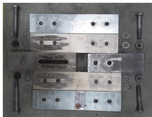
Figure 2.30 : Endommagement des cales 3M
