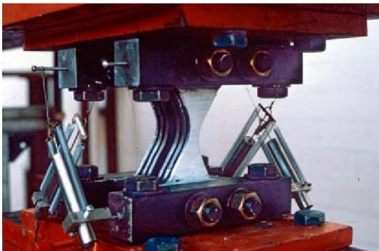
Figure 2.3 : Dispositif ADAS après essais
