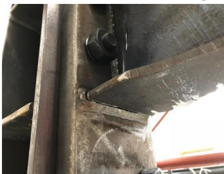
в) Разрушение в заваръчния шев от RBS 1A
