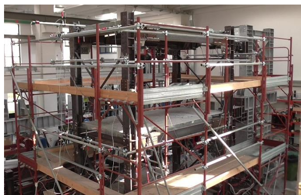
б) Тестов образец със съединения FREEDAM
