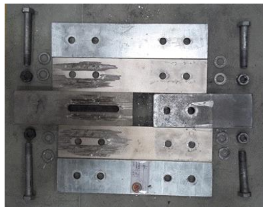
Фигура 2.30 – Повреди при подложки 3М
