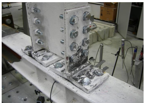
Фигура 1.5: Циклични зависимости момент-ротация за съединения с разделени свързващи фланцеви Т-профили, проектирани така, че Т-профилите да са най-слабия компонент [25]
