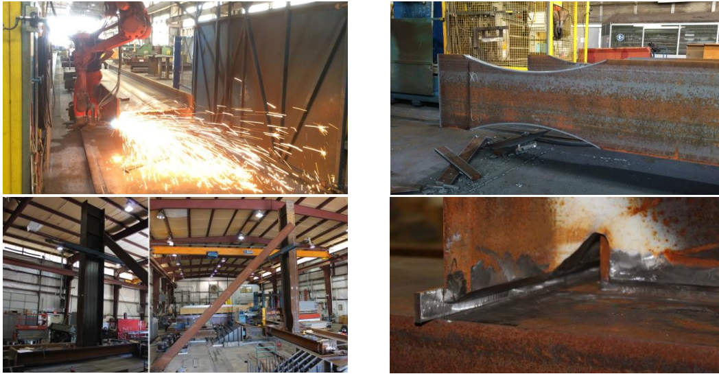
Figura 6.40: Fabricação dos provetes na oficina e soldadura no laboratório
