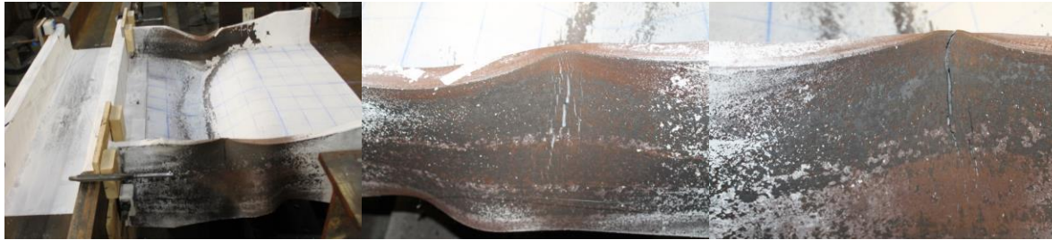
(a) (b) (c) Figura 6.42: Resposta experimental do provete SP2: (a) Deformação global da ligação; (b) e (c) Fissura no banzo da viga
