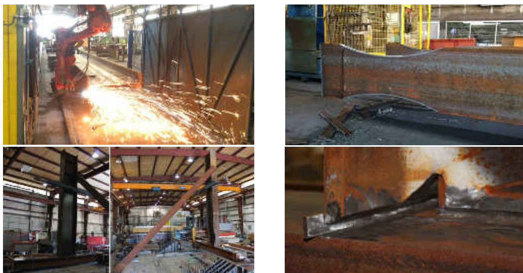
Figure 6.40: Fabrication des spécimens à l'atelier et soudage au laboratoire
